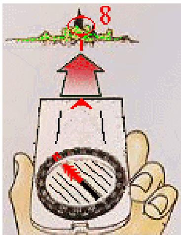
Prenez maintenant la boussole dans la main et tournez-vous jusqu'à ce que la pointe rouge de l'aiguille se trouve dans l'alignement de la marque nord de la capsule. La flèche de direction de la boussole vous indique maintenant la direction à suivre pour atteindre le poste 8.
